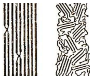
图 1 DyneemaSK60 和普通涤纶纤维分子结构的比较示意图
